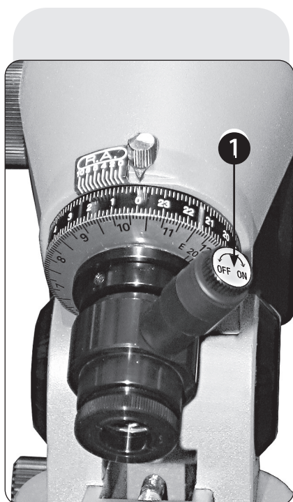
Fig. 6: Détail: viseur polaire. Eclairage du viseur polaire (1).
