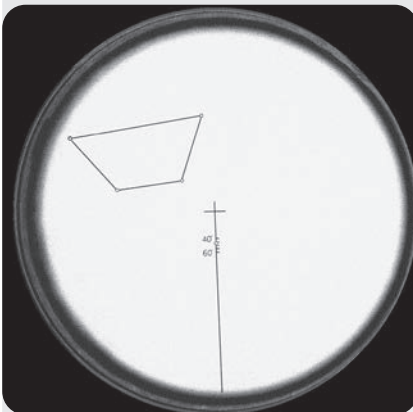
Fig. 36: Vista que se obtiene por el visor de alineación (las cuatro estrellas muestran una asociación cerca del polo sur celeste)
