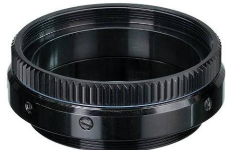
An der oberen Seite des Reducer/Field-Flattener befindet sich das T2 Außengewinde und zusätzlich noch ein M39x0,75 Innengewinde für den Anschluss der Kamera.
