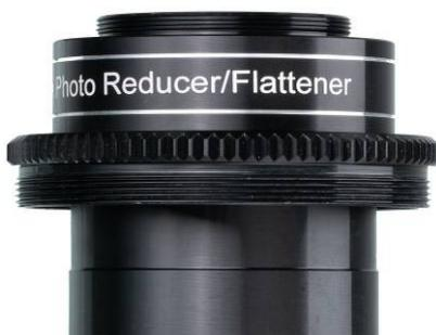
Sollten andere Gewinde zum Anschluss an das Teleskop benötigt werden, kann zunächst der flache Adapterring an das M54x0,75 Gewinde des Reducer/Field-Flattener angeschraubt werden. Dann steht Teleskop-seitig ein M68x1 Außengewinde zur Verfügung.
