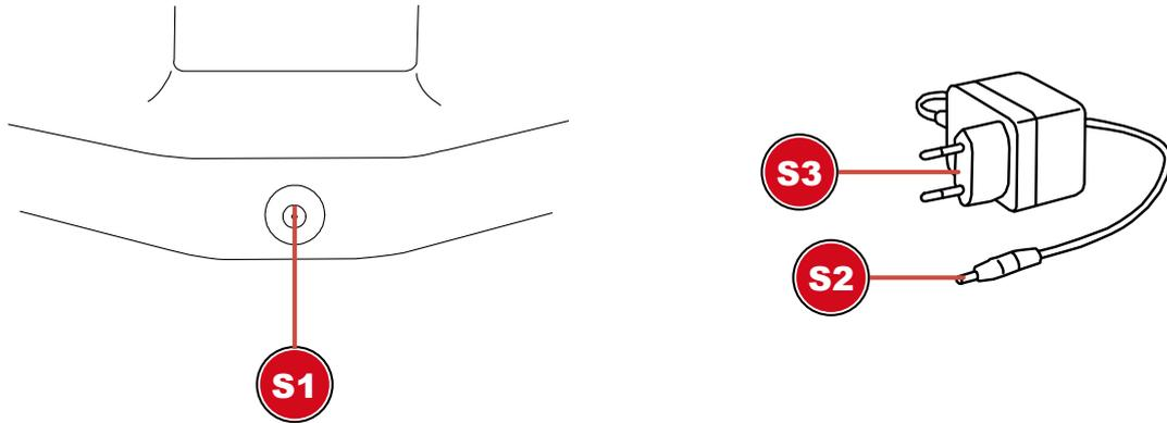
S1 Anschlussbuchse für DC-Hohlstecker
