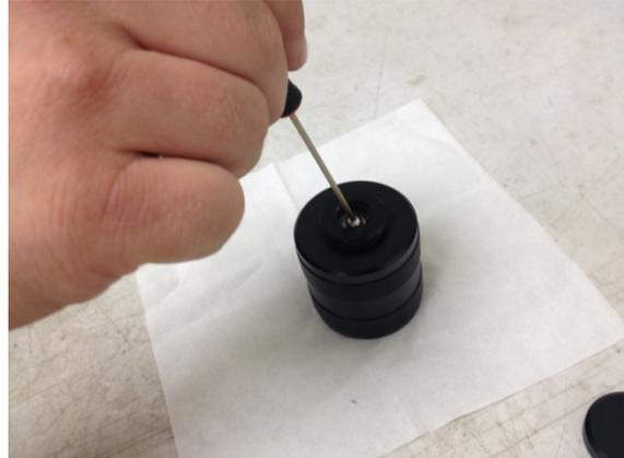
Schrauben Sie den großen schwarzen Handgriff des Pressure-Tuners von dem Messingzylinder ab. Am äußeren Ende des Handgriffs befindet sich eine Abdeckkappe, welche abgeschraubt werden kann. Unter dieser Abdeckkappe befindet sich eine Schraube, welche den Pressure-Tuner Kolben hält.
