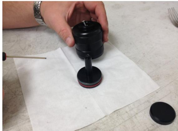
Mit einem 2,5mm Sechskant-Schlüssel (Inbusschlüssel) können Sie diese Schraube lösen und dann auf der anderen Seite den Kolben aus dem Handgriff herausziehen.
