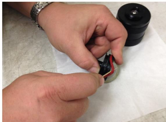
Nun können Sie die alten O-Ringe entfernen und die neuen einsetzen. Nach dem Wechsel der O-Ringe können Sie eventuell altes Fett entfernen und neues Teflon-Fett (Artikelnummer 0558350) auf die O-Ringe und den Messingzylinder auftragen.
