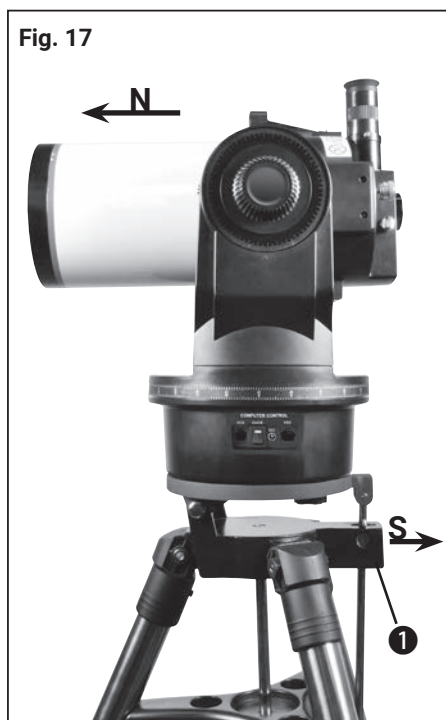
Azimuthal uitlijning: Kantelplaat en buis zijn horizontaal. De buisopening is naar het noorden gericht (N).
