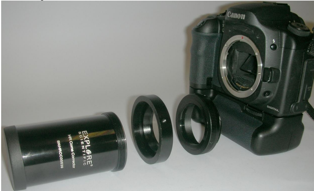
Abbildung 5: HR Coma Corrector mit T2-Adapter, T2-Ring und Kamera
