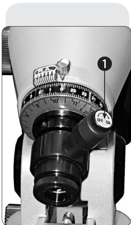
Fig. 6: Détail: viseur polaire. Eclairage du viseur polaire (1).
