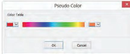
Wenn Sie ein monochromes Bild mit Pseudofarbe einfärben, muss eine spezielle Palette erstellt werden, mit der das monochrome Bild angezeigt wird. Bei der Pseudofarbgebung eines Bildes werden die Pixelwerte in der Bitmap des Bildes nicht verändert (das Bild wird nicht in eine echte Farbe oder Palette umgewandelt). Es wird einfach eine Pseudofarbpalette mit dem Bild verknüpft, die die Graustufenwerte im Bild als Farbe interpretiert.
