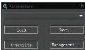
Die Gruppe Parameter dient zum Speichern der eingestellten Kamerasteuerungsparameter für die weitere Verwendung.
