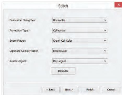
Panorama begradigen: Die Richtung, in der das Bild zusammengefügt wird. Sie kann horizontal, vertikal und ohne Angabe sein. Die Voreinstellung ist Horizontal;
