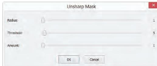
**Radius:** Beeinflusst die Größe der zu verstärkenden Kanten, so dass ein kleinerer Radius kleinere Details hervorhebt. Höhere Radiuswerte können Lichthöfe an den Rändern verursachen. Daher ist für feine Details ein kleinerer Radius erforderlich. Darüber hinaus stehen Radius und Betrag in Wechselwirkung zueinander; wenn Sie den einen reduzieren, können Sie den anderen stärker nutzen.
