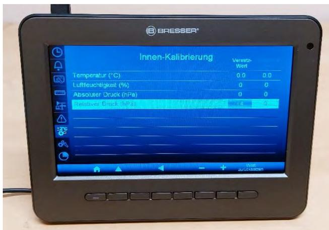
5.) Stellen Sie nun den Relativen Druck mit den + / - Tasten so ein, dass dieser die Differenz aufhebt.
