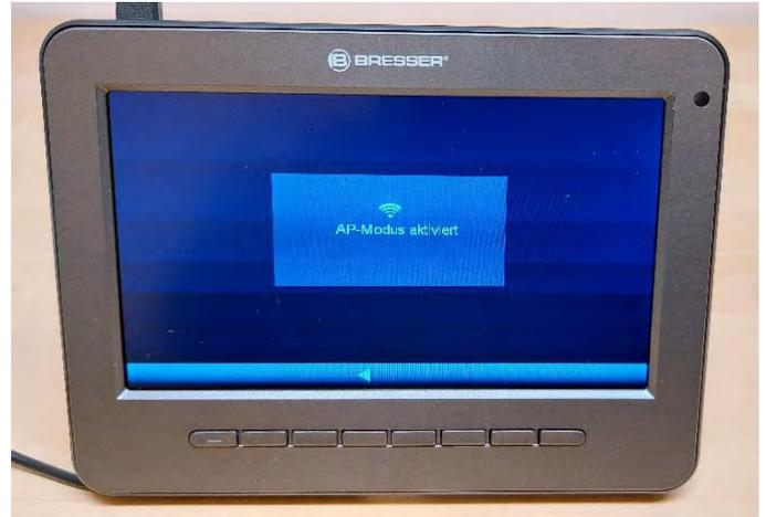
3. Die Basisstation erstellt ein eigenes Wi-Fi Netzwerk, mit dem Sie sich mit Ihrem Smartphone oder Wi-Fi fähigen Computer verbinden können. Suchen und verbinden Sie sich mit dem WLAN-Netzwerk der Wi-Fi Wetterstation (Beispiel: PWS-XXXXXX)
