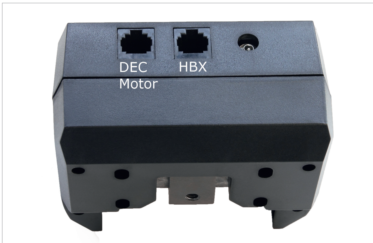
Fig. 1c: Panel de control del motor DEC
