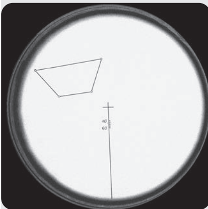
Abb. 36: Blick durch das Polsucherfernrohr. (Die vier Sterne zeigen eine Sterngruppe in der Nähe des Himmelssüdpols)
