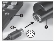
Ponga el conector redondo de 8 polos (G) del controlador (1) en la toma del motor de seguimiento (2).
