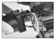
Ponga la pieza de conexión (B) del motor sobre el tornillo (C) del montaje como se muestra.
