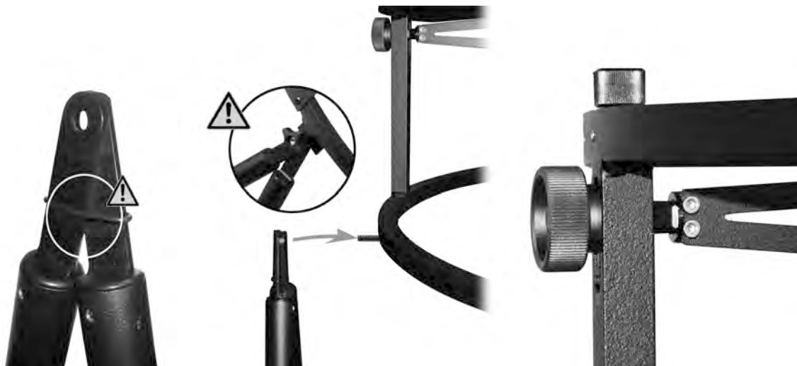
Fig. 5: Montaje de los tubos de celosía (izquierda) y las roscas de ajuste (derecha) en la caja del espejo secundario.
