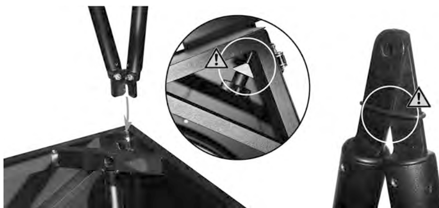
Fig. 3: Montaje de los tubos de celosía
