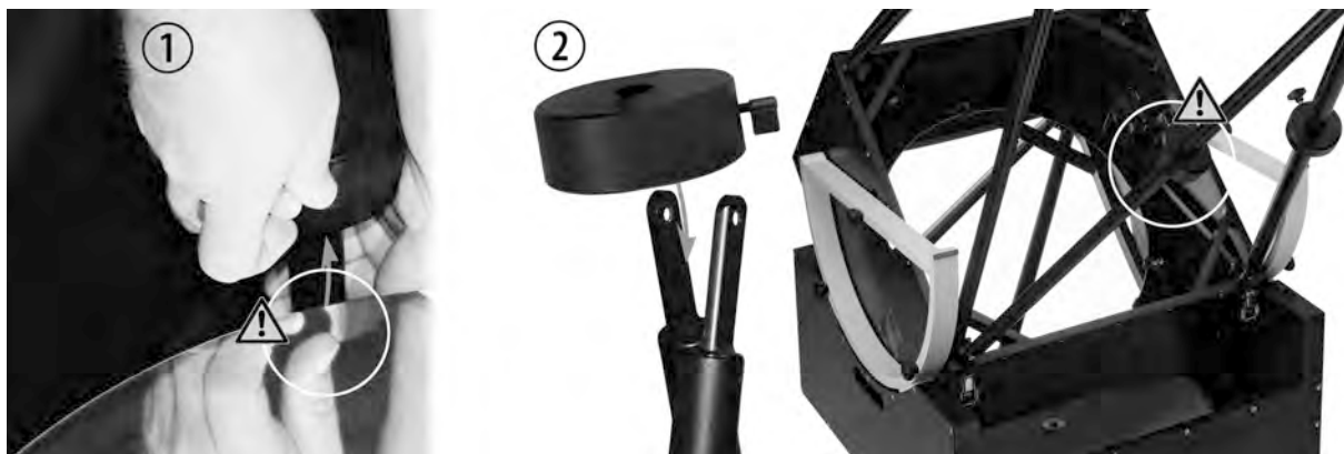
Fig. 4: Montaje de los contrapesos
