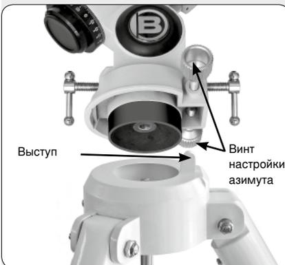
Рис. 5: Установка монтировки на треногу
