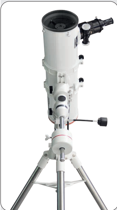
Fig. 16b: position de départ de l'alignement polaire (vue de face)
