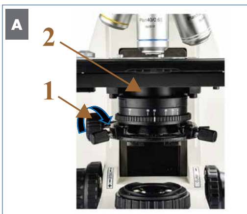
Illustration Q25 A/B: Dunkelfeld einstellen: Platzhalter am Kondensator entfernen.
