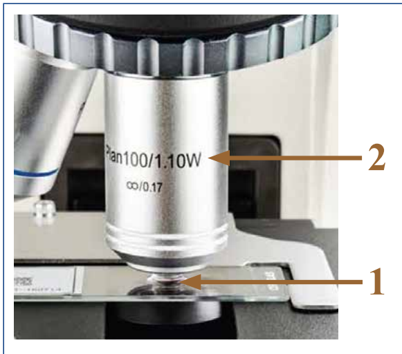
Abbildung 021: Verwendung des 100x Wasser-Immersionsobjektivs.
