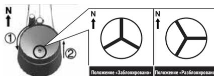
1. Поверните дождеприемник на 30° против часовой стрелки.
