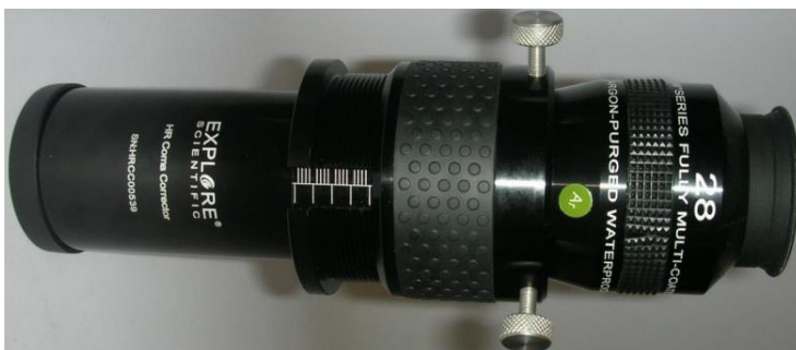
Figure 4 : HR Coma Corrector avec oculaire avec arrêt de champ à 3 mm en dessous de la référence
