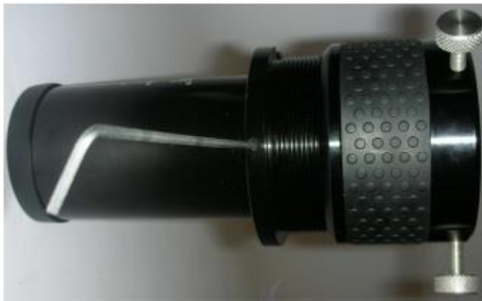
Figure 2 : Vue arrière avec la clé Allen de 2mm pour bloquer la bague
