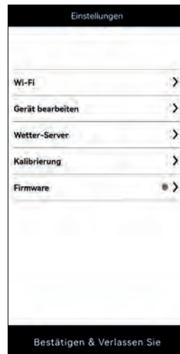
(b) Instellingenpagina (in STA-modus) U kunt een andere instellingenpagina oproepen door erop te tikken, behalve WI-Fi en firmware. Om de instellingen af te sluiten, tikt u op "Confirm & Exit" (Bevestigen & afsluiten).
